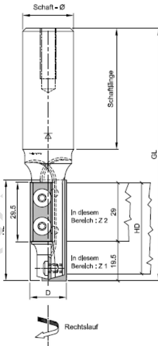
Mit diesem Fräser ist ein  $\varnothing$ -konstantes Arbeiten möglich ! Günstige Wendepatten kommen zum Einsatz für eine preisgünstige Bearbeitung auch von sehr abtrassiven Werkstückstoffen. Verschiedene Hartmetall-Qualitäten sind aus dem Standardbereich lieferbar.
