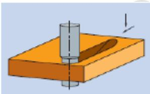
**Abbildung 3: Spiralförmiges Eintauchen „Auskreisen“**
