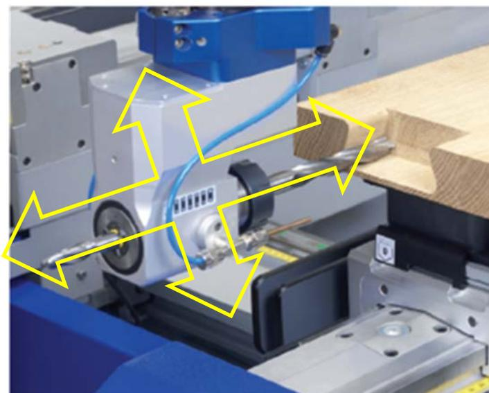
30. Die Saugerhöhe ist die Höhe des Saugersystems von der Konsole bis zur UK des Werkstücks. Die 100mm sind die **Unterfahrhöhe** des Systems, diese darf jedoch nicht ausgenutzt werden weil das Werkzeug sonst eine Kollision fährt.
