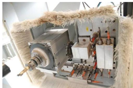
CNC-gesteuerte Bohraggregate für Horizontal und Vertikalbohrungen sowie Fräsaggregate zur Formatbearbeitung. Die Bohrer werden im 32mm-Raster als auch für Einzelbohrungen eingesetzt. Anwendung finden diese Aggregate im Plattenmöbelbau für Bohrungen zur Aufnahme von Verbindungsbeschlägen und Dübeln und zur Formatierung von ebenen Werkstücken. Die Aggregate sind fest an den Antriebsspindeln installiert.
