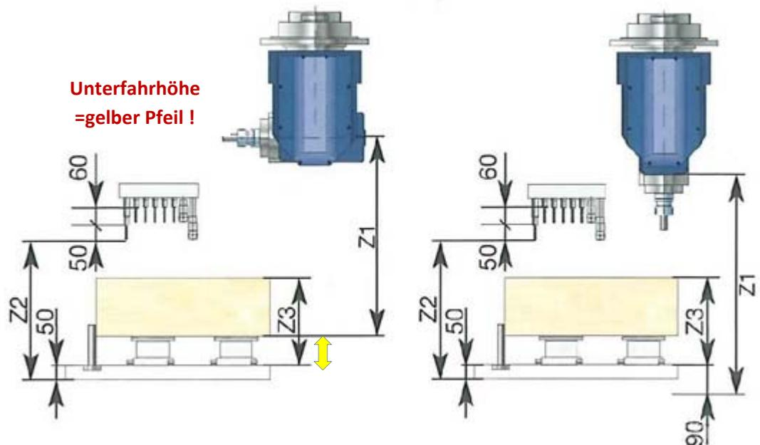
31. Die Überfahrhöhe beschreibt die Höhe die entsteht wenn ein maximal starkes Werkstück auf den Saugern aufliegt und die Maschine mit der Bohrgruppe und dem eingesetzten Werkzeug nicht mehr darüber wegfahren kann. Ein Beispiel wäre auf einer kleinen CNC eine dicke Haustür. Die Maschinensteuerung erlaubt also nur eine bestimmte Überfahrhöhe.
