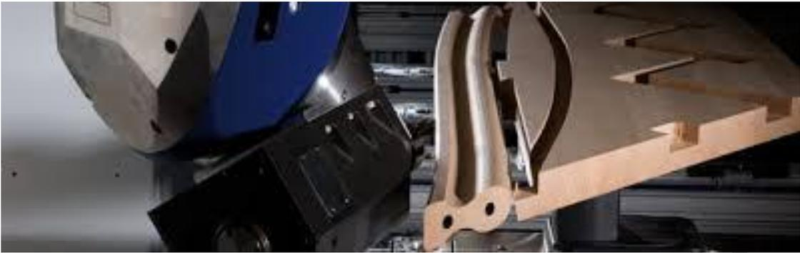
Gefräster Omegaprofil-Handlauf auf einer Homag 5-Achsmaschine an der Treppenwange. Durch die Fertigung an der Wange ergibt sich der die selbe Steigung des Handlaufprofils.
