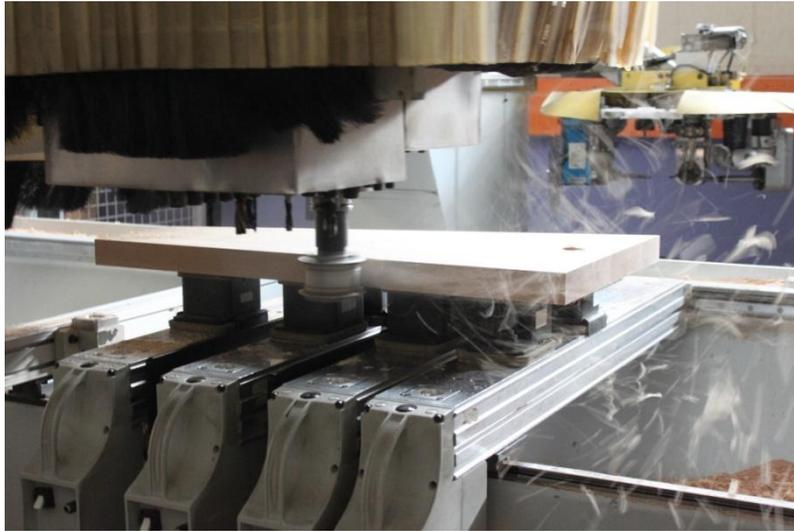
Die Stufenbearbeitung erfolgt mit einem VHW-Schruppfräser ähnlich wie bei der Treppenwange. Danach wird die Kante geschlichtet mit einer Abrund-Fügegarnitur. Spezielle Fräsungen mit einem kleinen Radius werden bei in der Stufe eingesetzten Pfosten benötigt. Auch wenn Setzstufen zur Anwendung kommen ein Kugelfräser zum Einsatz, dieser ermöglicht ein abfräsen der Enden.
