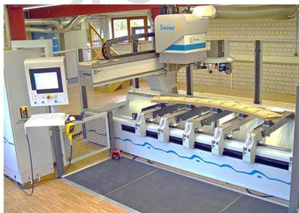
Die Treppenwangen werden grob auf Maß vorgerichtet und dann mit einem VHW-Schruppfräser vorformatiert. Nach dem Schruppfräsen folgt das Schlichten mit einem Schlichtfräser oder einer Abrundfügegarnitur, diese frägt und fräst gleichzeitig die Radien an. Die Stufenausfräsungen erfolgen auch mit dem Schruppfräser hier muss auf die gewünschten Radien geachtet werden. Die Radien ergeben sich aus dem später eingesetzten Stufenquerschnitt.
