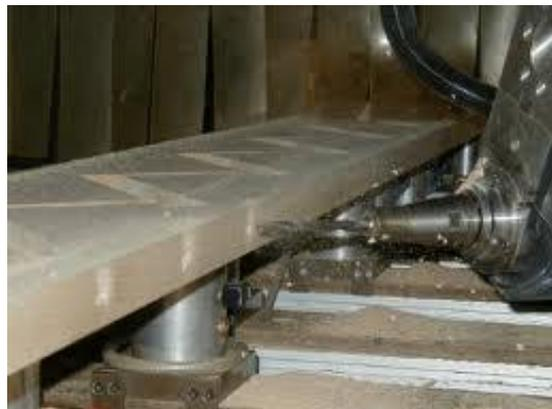
48. Wangenbearbeitung auf einer Treppen-CNC-Maschine
