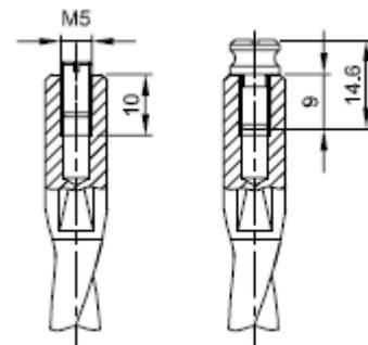
Die Durchgangslochbohrer C275 sind zur Herstellung von Durchgangslochbohrungen geeignet und werden z.B. bei Korpusmöbel für die Verbindungsschrauben eingesetzt. Ein DB-Bohrer reißt durch seine Spitzenform nicht aus wenn er durch die Plattenrückseite austritt.
