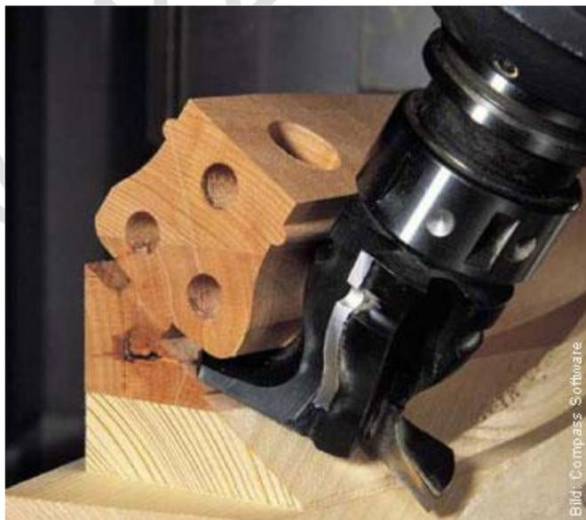
Omegakrümmling im ganzen Stück auf einer 5-Achsmaschine bearbeitet. In spezieller Faserrichtung verleimter Krümmling. Auf den CNC-Maschinen kommen spezielle Softwareprogramme zum Einsatz wie Kompass usw.!
